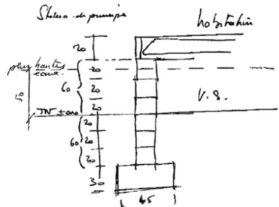
**Schéma 2 : mesures techniques d'adaptation à 30 000 euros : construction sur sous sol non enterré.**
